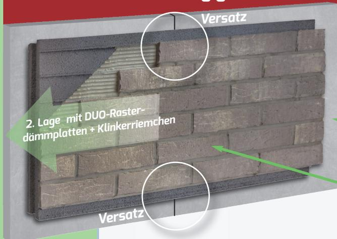
Der **2-fach-Schutz** für noch mehr Sicherheit gegen Wärmebrücken und eindringende Feuchtigkeit im Bereich der Element-Ansätze – **damit Schimmelpilzbildung im Inneren des Hauses keine Chance hat!**
